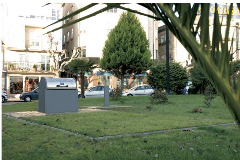
Marco "ergonomic", construído em chapa de inox de 3mm. Pintura com acabamento anti-grafitti.
